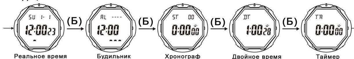
1. В любом состоянии нажмите клавишу (А), светодиодная подсветка загорится на 2 секунды, нажмите клавишу (Б), чтобы выбрать различные режимы.
