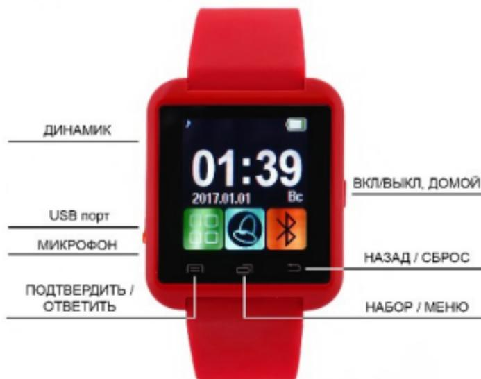
\*Вкл/Выкл, Домой: В спящем режиме часы показывают время. Для того, чтобы выйти из спящего режима нажмите клавишу один раз.
