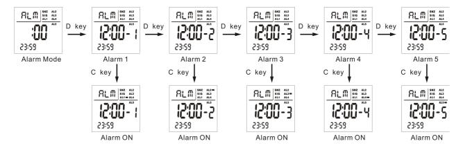
В режиме будильника нажмите клавишу C, чтобы открыть: Режим будильника  $\rightarrow$  Будильник  $1 \rightarrow$  Будильник 1 ВКЛ.  $\rightarrow$  Отложить ВКЛ;
